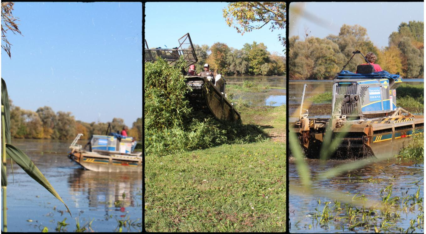
V.N.F a mis en oeuvre dernièrement une vaste opération d'arrachage de cette plante pour la détruire et éviter ainsi qu'elle se propage. Deux machines amphibies avec chenilles rentrent dans l'eau et l'arrachent, les chauffeurs font des tas sur les berges. Les végétaux arrachés sont transportés par camion sur un terrain afin de les laisser sécher pour être ensuite épandus comme amendement dans les champs.
